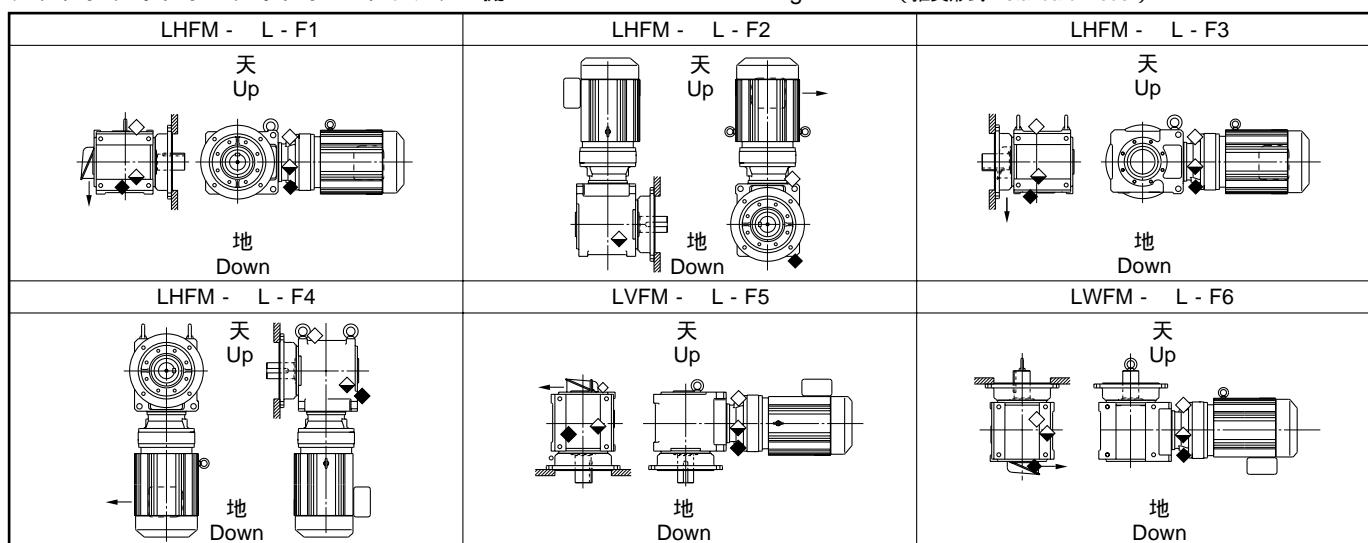
ソリッドシャフト シャフトR フランジ L側 Solid Shaft Shaft R Flange L Side (準推奨形式 semi standard model)
